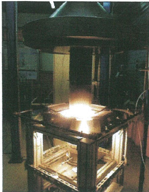
Figure 28 : Essais de combustion d'une cellule amorphes (Unisolar)
